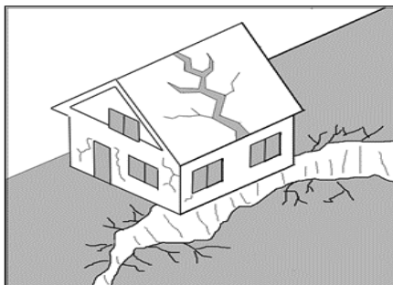
รูปที่ 16 รูปตัวอย่างการหลุดตัวของพื้นดินบริเวณที่ตั้งอาคาร
